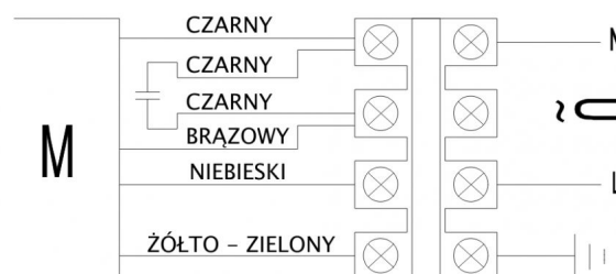
SCHEMAT ELEKTRYCZNY SILNIKA JEDNO-FAZOWEGO
